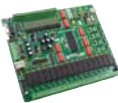
**PICPLC16B** est un système à installer tel quel ou à utiliser pour le développement d'applications industrielles, professionnelles ou privées. Caractéristiques : 16 relais, 16 entrées opto-isolées, RS-485, RS-232, Ethernet etc.
