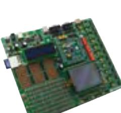
Système de développement pour microcontrôleurs **ARM** à 64 et 144 broches (livré avec le Philips LPC2148). Programmeur USB 2.0 ultra rapide et contrôleur pour dalle tactile intégrés.
