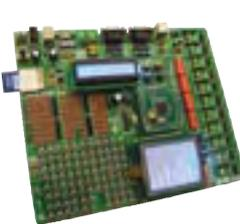
Système de développement pour microcontrôleurs **AVR** à 64 et 144 broches (livré avec un ATMEGA128 scandé à 10 MHz). Programmeur USB 2.0 ultra rapide et contrôleur pour dalle tactile intégrés.
