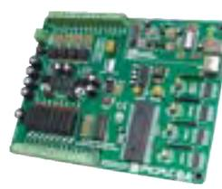
**PICPLC8A** est un système à installer tel quel ou à utiliser pour le développement d'applications de commande industrielle. Caractéristiques : 8 relais, 8 entrées opto-isolées, RS-485, RS-232, PS/2. Programmeur USB 2.0 et mikroICD intégrés.
