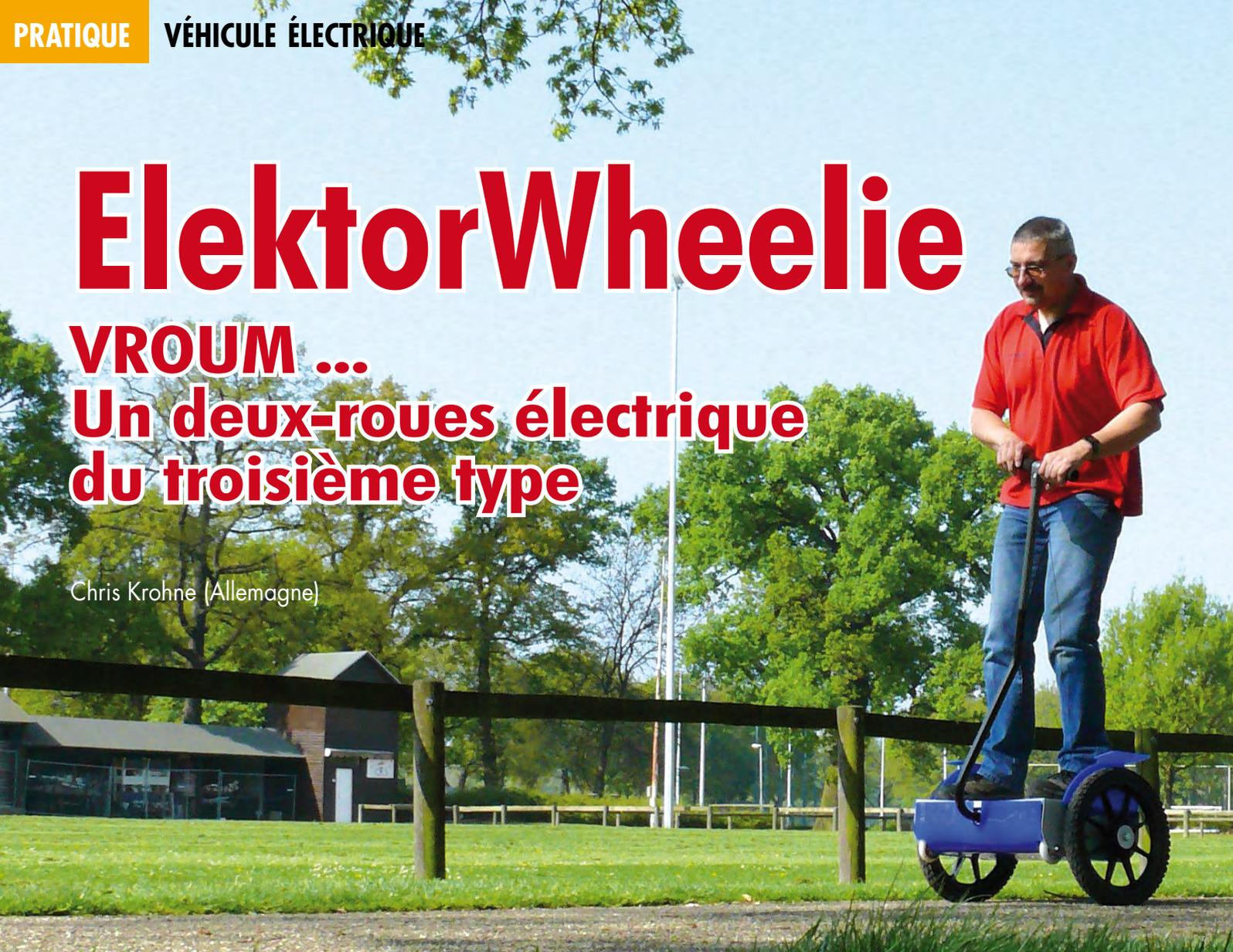
**Comment construire soi-même ce véhicule électrique à un seul axe autostabilisé ? Nous vous donnons, dans ce premier article, les clés de la composante électronique. Un ATmega32 traite les données du manche de commande et des capteurs. Il s'en sert pour régler, pour chacun des deux moteurs, leur niveau de puissance, responsable de la direction et de la vitesse de déplacement, entre l'arrêt sur place et 18 km/h, mais aussi de l'assiette de la plateforme du deux-roues.**
