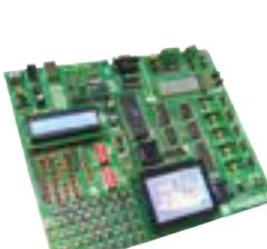
Système de développement pour microcontrôleurs 8051 à 14, 16, 20, 28 et 40 broches (il est livré avec un AT89S8253). Supports PLCC44 et PLCC32, programmeur USB 2.0 ultra rapide et contrôleur pour dalle tactile intégrés.
