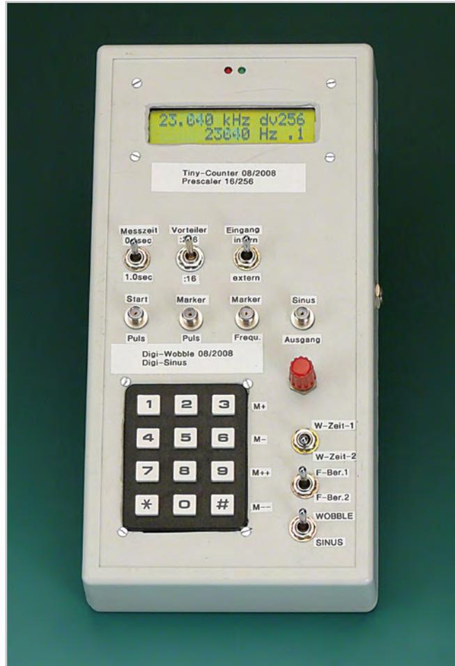
plage utilisable va de 10 Hz à 500 kHz. Pour une fréquence de 12 kHz par exemple, la saisie est : \*12000#.
