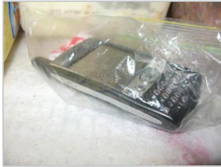
tion par défaut. Ici, plutôt que de se hasarder à manœuvrer des cavaliers, on provoquera une décharge profonde via le froid.
