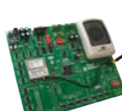
**SmartGSM/GPRS** est un outil de développement qui aidera à bien comprendre les technologies GSM & GPRS. Il est possible de monter une antenne sur la carte pour une meilleure qualité de signal. Le système accepte différents modules GSM.
