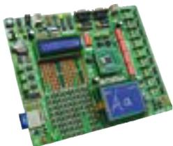
**BIGPIC5** accepte les derniers microcontrôleurs **PIC** à 64 et 80 broches (il est fourni avec un PIC18F8520). Programmeur USB 2.0, mikroICD et contrôleur pour dalle tactile intégrés.
