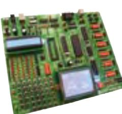
Système de développement pour microcontrôleurs dsPIC à 18, 28 et 40 broches (livré avec un dsPIC30F4013). Programmeur USB 2.0, mikroICD et contrôleur pour dalle tactile intégrés.
