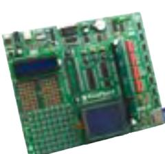
Système de développement pour microcontrôleurs **PSoC** à 8, 20, 28 et 48 broches (il est livré avec un CY8C27643). Programmeur USB 2.0 ultra rapide et contrôleur pour dalle tactile intégrés.
