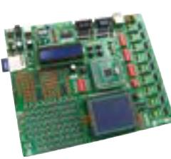
**LV18FJ** est un système de développement pour microcontrôleurs **PIC18FxxJxx** à 64, 80 et 100 broches (livré avec un PIC18F87J60). Programmeur USB 2.0, mikroICD et contrôleur pour dalle tactile intégrés.
