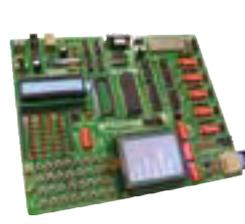
Système de développement pour microcontrôleurs **AVR** à 8, 14, 20, 28 et 40 broches. Il est livré avec un ATMEGA16. Programmeur USB 2.0 ultra rapide et contrôleur pour dalle tactile intégrés.
