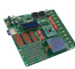
Système de développement pour microcontrôleurs **PIC24F**, **PIC24H** et **dsPIC33F** à 64, 80 et 100 broches (livré avec un PIC24FJ96GA010). Programmeur USB 2.0 et contrôleur pour dalle tactile intégrés.
